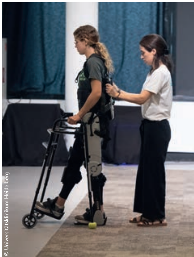
Abb. 4: Patientin während der Lokomotionstherapie mit dem ABLExo-Exoskelett (Quelle: ABLExo Motion, Barcelona, Spanien)
