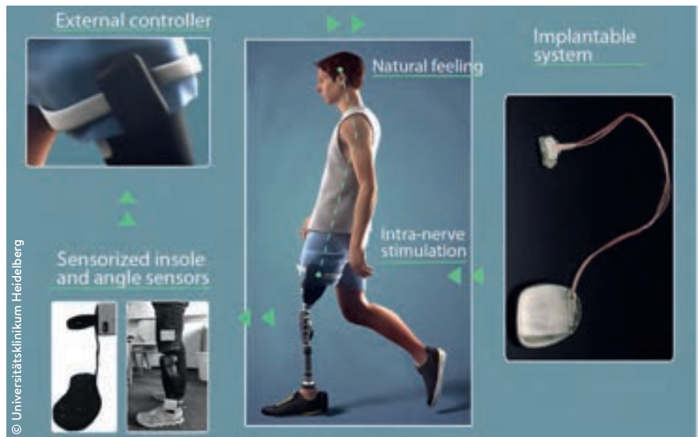
Abb. 3: Schema eines Neuro-interface (Sensy) zur sensiblen Stimulation bei vorliegender Amputation (Quelle: www.sensars.com )
