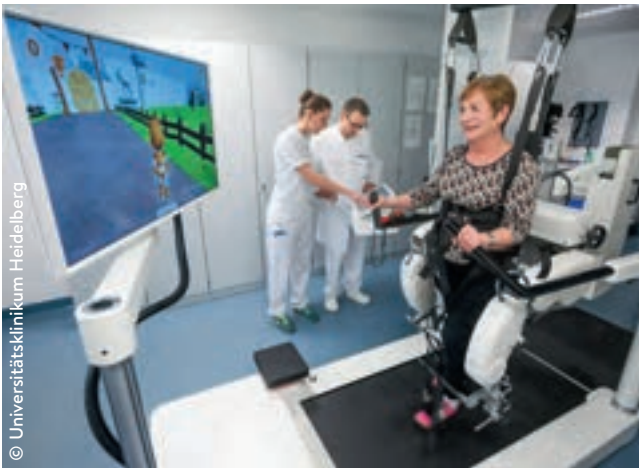
Abb. 5 Robotergestütztes Laufbandtraining unter partieller Gewichts-entlastung mit spielerischen Feedbackkomponenten
